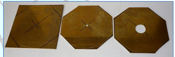
Figure 19 Étapes de préparation des tôles
