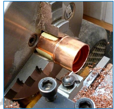
Figure 26 Usinage et protection de la pièce
