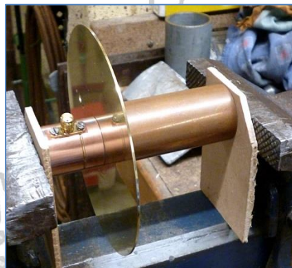
Figure 30 compresser le réflecteur de l'antenne patch sur le guide au moyen d'un morceau de tube
